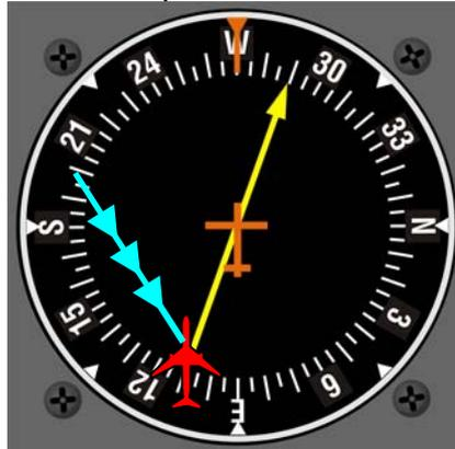
Der Wind aus 240° bläst Sie vom QDM 305 weg mit einer Querwindkomponente von 26 KT. Das Flugzeug kommt zum QDM 305 langsamer als bei Windstille, oder gar nicht.
