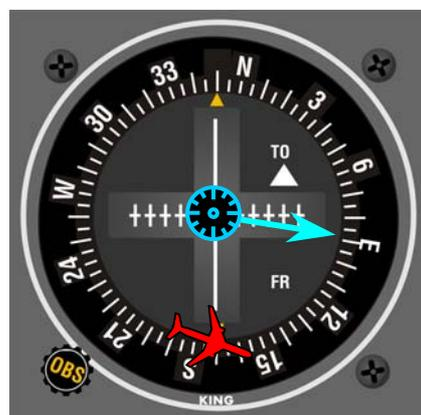
Das Heading 090 steht unterhalb von querab. Die DME Anzeige wird größer.
