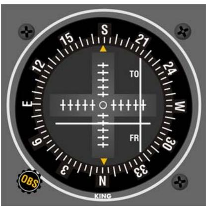
**NAV 2 VOR** Der Front Course ist oben. Die Einstellung am OBS ist für den CDI bedeutungslos. Das Heading 358° differiert mit dem Front Course um ca. 180°. Das Gerät arbeitet am Back Course als Anzeigegerät.
