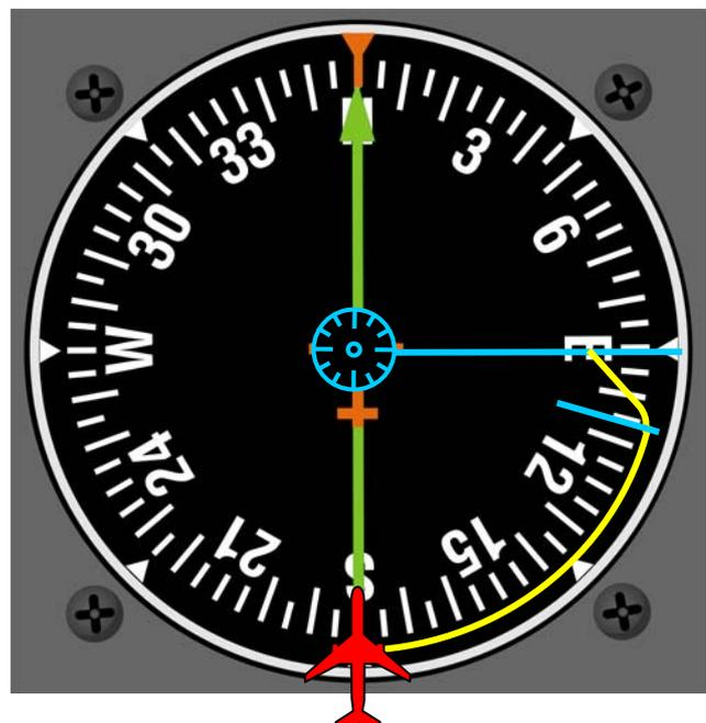
Das Flugzeug befindet sich am Radial 180 und fliegt inbound zur Station.
