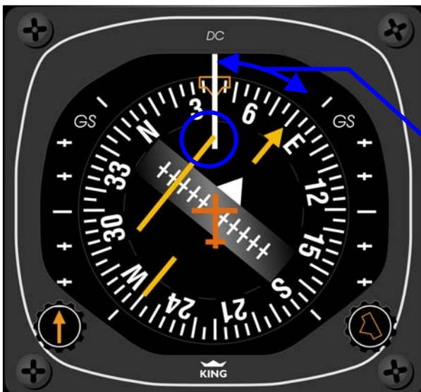
indem sie das Ende des CDI an der Lubber Line anstehen lassen. Der Winkel zwischen Pfeil und Lubber Line ist der Intercept Winkel.
