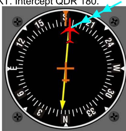
Der Wind aus 240° bläst Sie zum QDR 180 hin mit einer Querwindkomponente von 26 KT. Das Flugzeug kommt rascher zum QDR 180 als bei Windstille.
