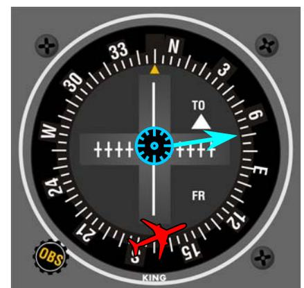
Das Heading 070 steht oberhalb von querab. Die DME Anzeige wird kleiner.
