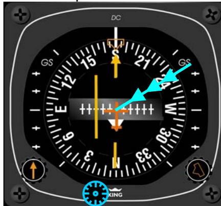
Der Wind aus 240° bläst Sie zum Radial 180 hin mit einer Querwindkomponente von 26 KT. Das Flugzeug kommt rascher zum CDI als bei Windstille.
