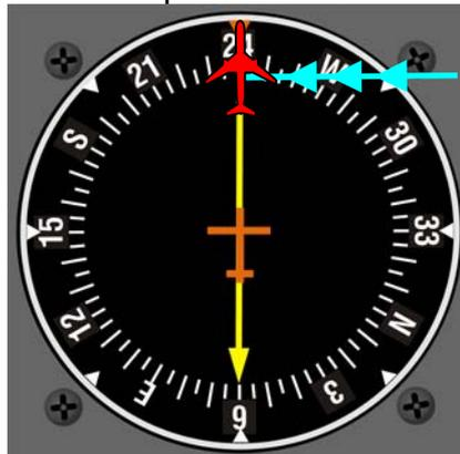
Der Wind aus 330° bläst Sie vom QDR 240 weg mit einer Querwindkomponente von 30 KT. Das Flugzeug wird nach links vom QDR 240 weggeblasen.
