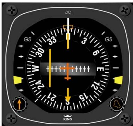
**NAV 1 HSI** Das Heading 358 ist oben. Das HSI ist richtig eingestellt. Die Pfeilspitze steht auf den Front Course 178°, der CDI steht dadurch auf der richtigen Seite. Das Gerät arbeitet als Kommandogerät, auch am Back Course.
